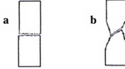
Şekil 2. (a) Gevrek malzemenin kırılma şekli (b) sünek malzemenin kırılma şekli.
